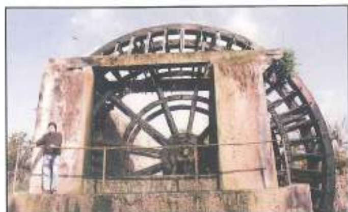
Figura 79. Noria de tracción hidráulica de las Vegas del Segura. Construida de madera con el eje metálico.
