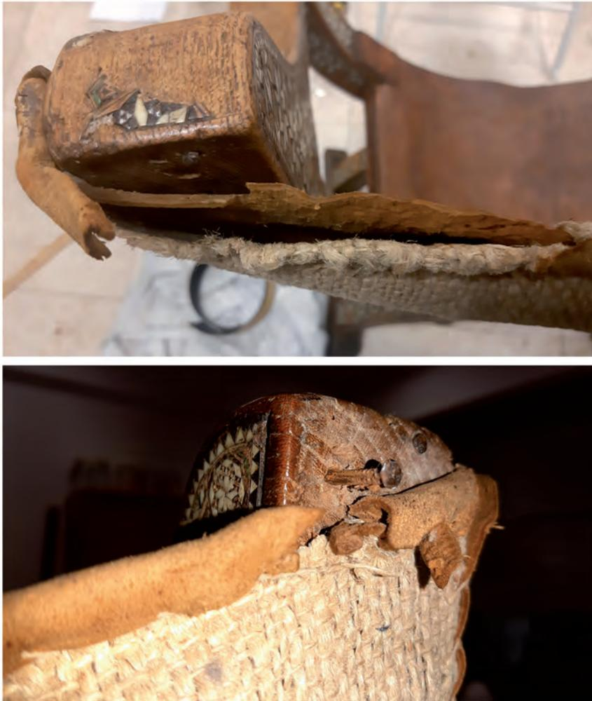
**Fig. 20.** Descosido y falta de soporte en el respaldo de las *Jamuga 1* y *Jamuga 2* respectivamente.
