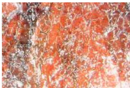
13. Macrofotografía x100 de microcraquelado.
