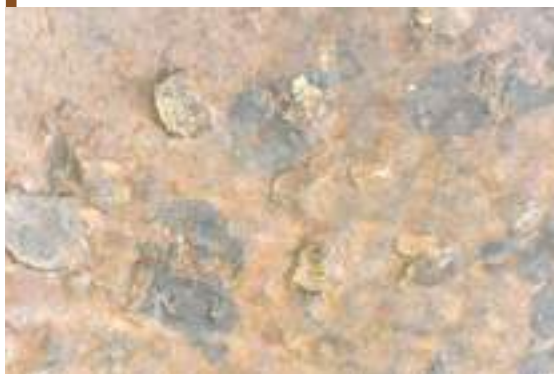
11. Macrofotografía x200 productos de oxidación natural no reactiva, \text{Cu}_2\text{O} .
