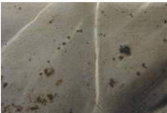
15. Detalle de los micro productos de oxidación estable de óxido de cobre (II).
